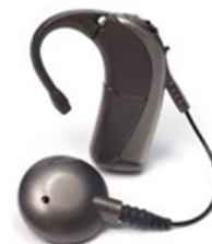
Figura 5. Procesador retroauricular Harmony de investigación, con capacidad de almacenar mediciones diarias de impedancias por largos periodos
